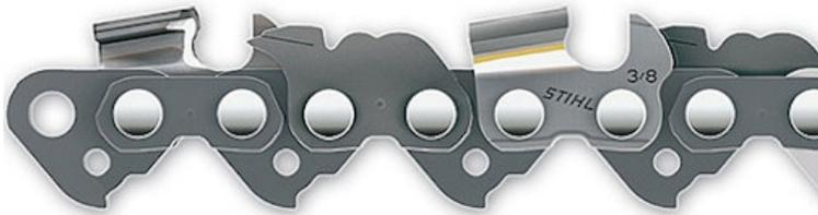
Spezial-Sägekette für härteste Einsätze von Feuerwehr, Rettungsdiensten und Technischem Hilfswerk (z. B. Holz mit Nägeln, Verbundmaterial und Panzerglas). Schneidezähne mit vollflächiger Aufpanzerung aus schlagzähem Hartmetallplatten
